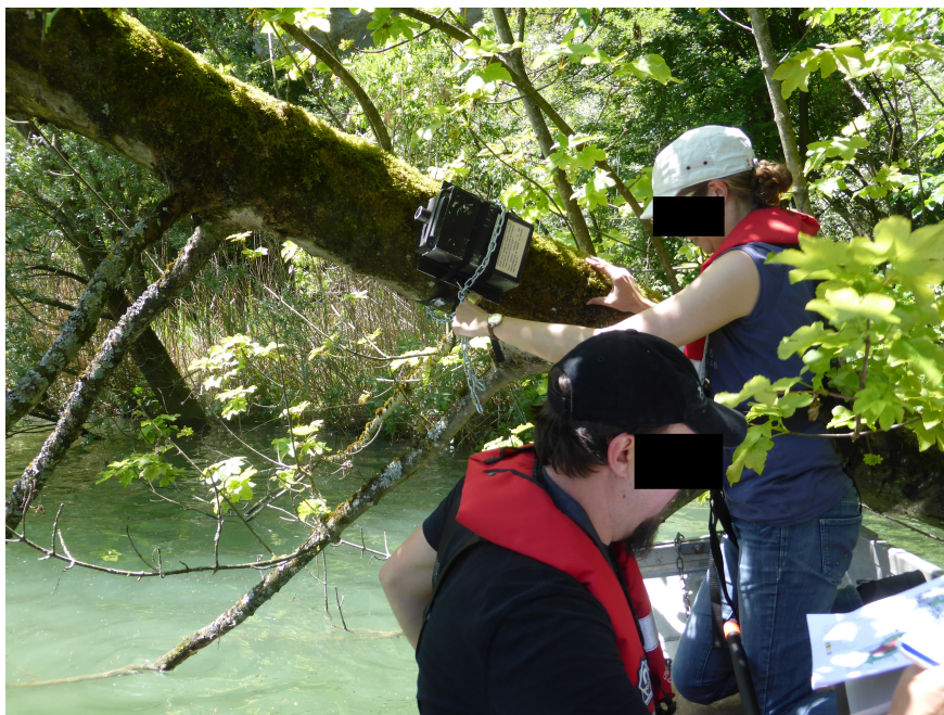
FIGURE 2.8 – Mise en place d'un des systèmes d'enregistrement des ultrasons émis par les chauves-souris au niveau du Lac de Pérolles.
